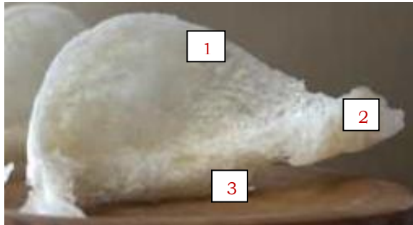
Gambar 3. Peletakkan 3 thermocouple pada mangkok, kaki dan perut dari produk tipe mangkok sarang burung walet
